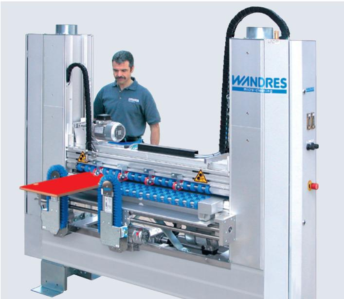
Beidseitige Reinigung von Möbelplatten mit zusätzlicher Kantenreinigung
