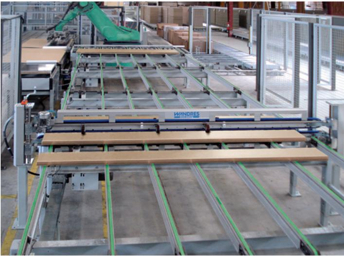
Einfache Integration der Kombi-Schwertbürste KSB 123.. in vorhandenes Fördersystem zur beidseitigen Reinigung von Möbelplatten
